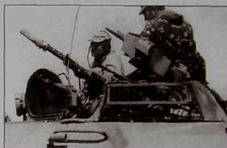
БТР-70Г 3 роты 154 оо СпН. Бронетранспортер БТР-70Г, кроме спаренных пулеметов КПВТ и ПКТ, был вооружен и сокурсным с ними 30-мм автоматическим гранатометом АГ-17 (боекомплект 195 выстрелов ВОГ-17). Джелалабад, 1986 г.
