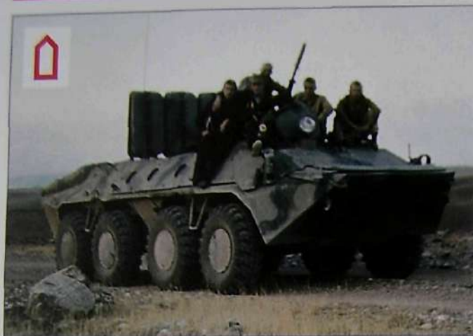
Бронетранспортер с дополнительным бронированием бортов БТР-70Д. Для предотвращения перегрева двигателей в высокогорье и в летнюю жару водители были вынуждены поднимать бронированные крышки силового отделения БТР-70. 154 оо СпН, провинция Нангархар, 1987 год.
