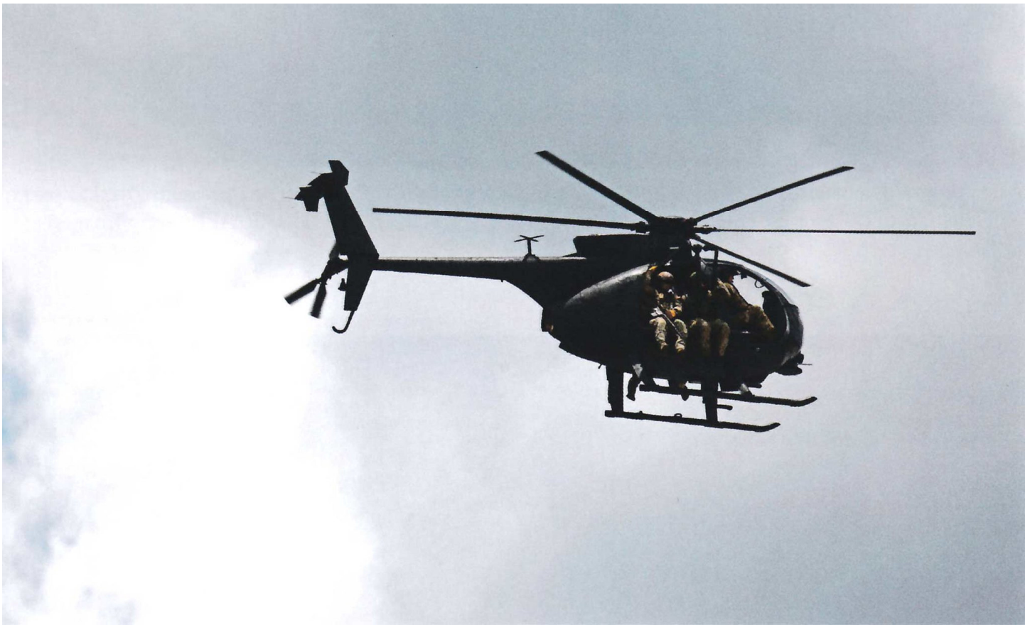
Фотография современной "Маленькой Птички" МН-6, на которой хорошо видны "людские подвески" и кронштейны крепления спусковых канатов. (Люк Шерретт 4 / Bloomberg / Getty Images)
